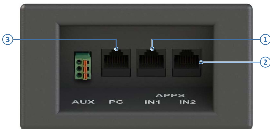
Abb. 2: Rückseite des APPS-EDU mit Anschlüssen
